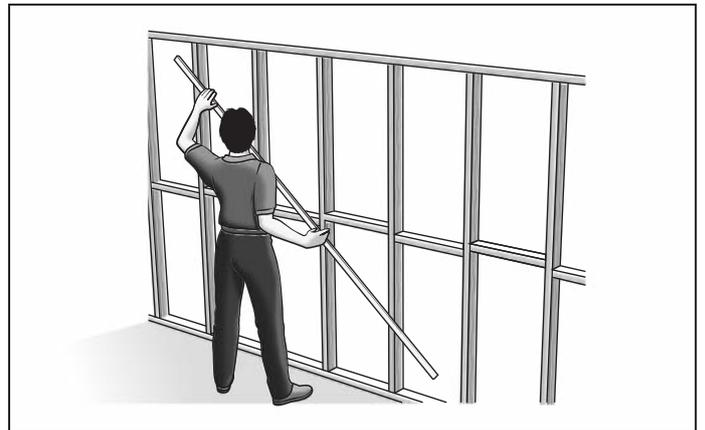
FIGURE 1 FRAME STRAIGHTNESS
